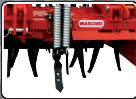
FALCO - AQUILA - AQUILA R - JUMBO R Coppia rompitraccia a molla • Pair of spring-type wheel track eradicators • Jeu de dents efface trace à dents
