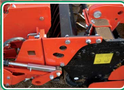
FALCO - AQUILA - AQUILA R Attacco rapido su versione combinata • Quick hitch on combined version • Attelage rapide sur version combinée
