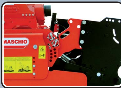
FALCO - AQUILA Regolazione rullo a perni • Rear roller with pin adjustment • Réglage rouleau par broches
