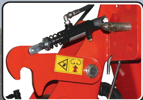
FALCO - AQUILA - AQUILA R - JUMBO R Chiusura sicurezza idraulica • Hydraulic safety closing • Fermeture hydraulique de sécurité
