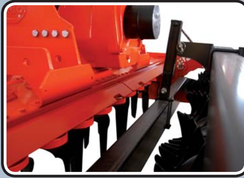
FALCO - AQUILA - AQUILA R - JUMBO R Barra livellatrice montata su rullo con mart. mecc. di regolazione • Levelling bar mounted on roller with mechanical adjuster • Barre niveleuse montée sur rouleau avec manivelle mécanique de réglage
